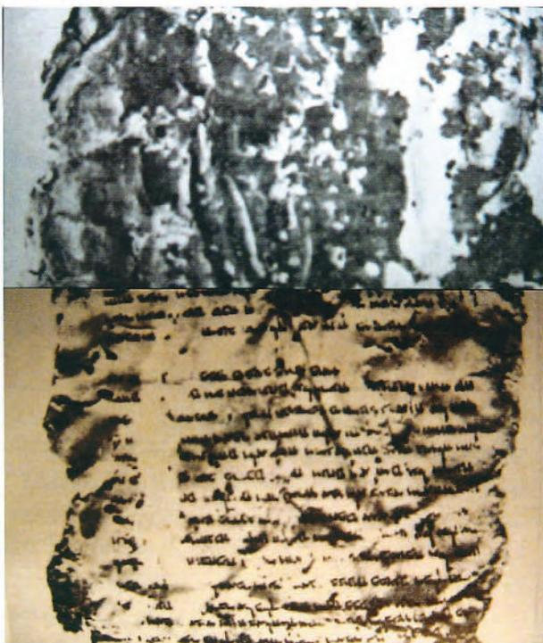
La fotografia con il materiale negativo all'infrarosso, viene eseguita mediante emulsioni che portano incorporate delle sostanze che le rendono sensibili alle lunghezze d'onda maggiori di quelle che usiamo normalmente (rotolini per foto di materiale ortocromatico o pancromatico).
